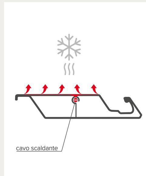
**Snow Melt:** è il sistema di riscaldamento della superficie superiore delle lame in grado di prevenire la formazione e l'accumulo della neve sulla copertura. Permette di mantenere chiusa la copertura anche in presenza di precipitazioni nevose. Disponibile per Med Varia e Med Twist.
