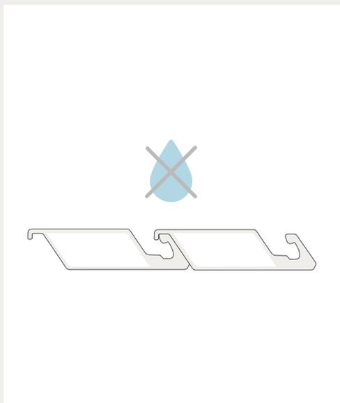
**Blade Seal:** sistema di tenuta tra le lame con speciale guarnizione multi-aletta che garantisce più punti di contatto concorrendo efficacemente a garantire l'impermeabilità all'acqua ed all'aria tra lama e lama.
