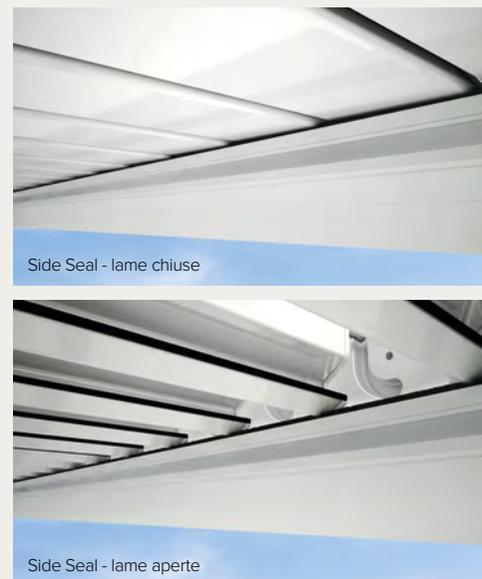
**Side Seal:** è il brevetto che descrive il sistema di tenuta perimetrale delle lame poggianti su una guarnizione lungo il bordo interno che garantisce il perfetto isolamento dall'ambiente esterno. A completamento, ogni lama, per tutta la sua lunghezza, monta una guarnizione su cui poggia la lama adiacente in chiusura, garantendo l'impermeabilità all'acqua e all'aria.
